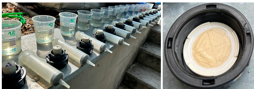
Obr. 2: Vlastní soupravy na filtraci vody včetně kapsle s kruhovým nanofiltrem. Ukázka filtračního koláče po filtraci.
