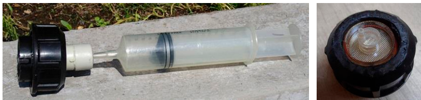
Obr. 1: Části filtrační soupravy vlastní konstrukce na nanofiltraci vody s použitím nanofiltru
