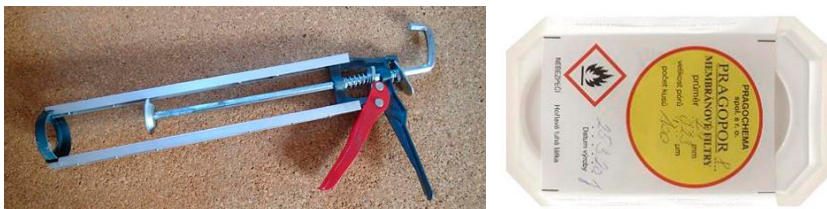
Obr. 2: Filtrace vody s délkově upravenou vytláčovací pistolí a kruhovými výseky nanofiltru
